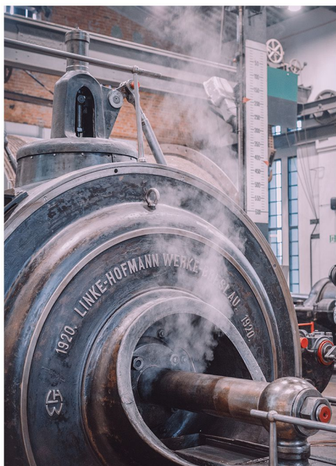
100-letnia maszyna wyciągowa o napędzie parowym
